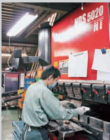
HDS-5020NTのAMNC/PCで曲げ加工データを呼び出して加工する。
