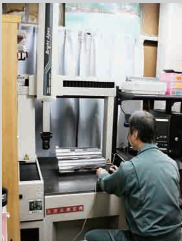
3次元測定器で製品検査を行う。
